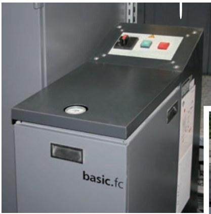
Système de filtration des eaux de mouillage
