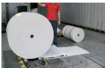
Station de démaculage de bobine motorisée
