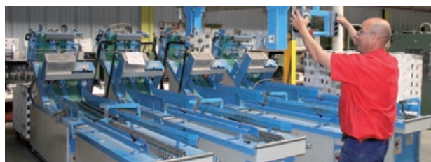
Margeur Streamfeeder avec pince de chargement robotisée
